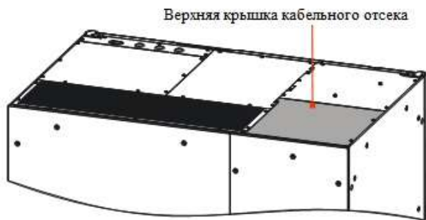
Рисунок 3.36 Расположение верхней крышки АБ-КР 33/800, закрывающей зону электрических подсоединений
