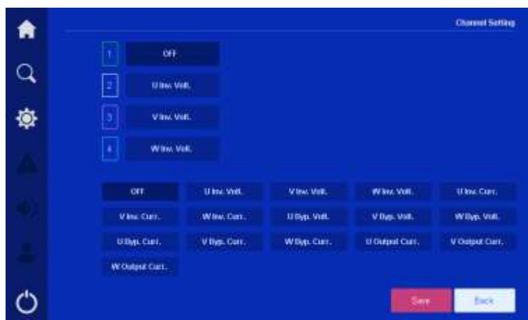
Рисунок 4-23. Настройка и выбор каналов для страницы с изображением формы волны при отказе.
